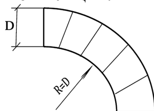
Рис. 6. Сегмент круглого отвода воздуховода для общеобменной системы вентиляции.
