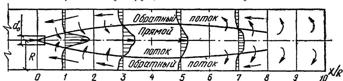
Рис.3. Схема струи, истекающей в тупик
